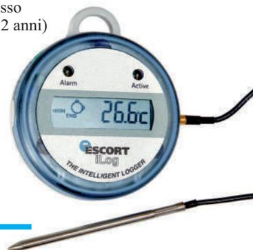
**82D32** Data logger temperatura a 2 canali con 1 sensore interno ed 1 sonda esterna in acciaio a punta  $\varnothing 4\text{mm}$  L= 80mm con 1m di cavo. Campo di lavoro sonda esterna da  $-100 \dots +40$ °C. Tutte le altre caratteristiche tecniche rimangono identiche al 62D32.
