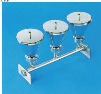
Per la filtrazione sotto vuoto simultanea di 3 campioni. Consente di utilizzare portafiltri in vetro o acciaio inox muniti di tappi in silicone forati n. 8 sulle uscite.
