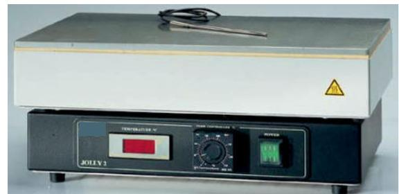
La struttura esterna è in lamiera d'acciaio verniciata a forno con polvere epossidica antiacida. Piastra riscaldante in alluminio con spessore di 8 mm. Il controllo elettronico della temperatura avviene tramite un microprocessore a azione PID con sonda PT 100 posta al di sotto della piastra. Possibilità di impostare un timer di funzionamento.
