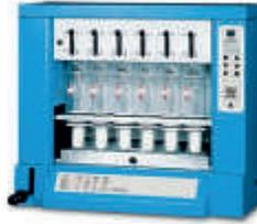
L'unità SER 148/3-6 permette la separazione quantitativa di una sostanza o di un gruppo di sostanze (es. grasso) da una miscela di solidi o semisolidi.
