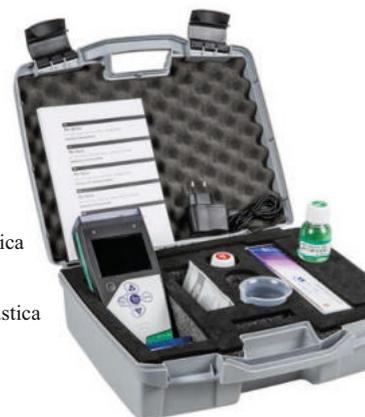
I tester, per il controllo del pH e del redox, sono leggeri e possono stare comodamente in tasca. Tutti i modelli sono a tenuta stagna IP67. La serie 1 è caratterizzata da corpo trasparente, largo display LCD, sensore non sostituibile e utilizza 4 batterie 1,5mV AAA o batteria ricaricabili.
