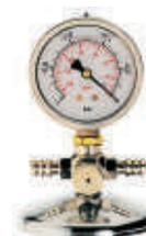
**VACUOMETRI di BENNERT MANOMETRI ad ARIA LIBERA ad "U"**
