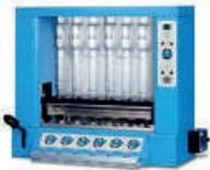
I campioni da sottoporre alla determinazione della fibra grezza devono avere un contenuto di grassi inferiore a 1%. Se il contenuto di grassi è superiore o uguale all'1%, è necessario effettuare uno sgrassamento preliminare utilizzando acetone, esano o etere di petrolio.
