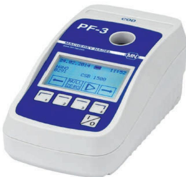
Il nuovo fotometro compatto PF-3 è un fotometro portatile di facile utilizzo dotato di ottica ad elevata precisione con LED e filtri interferenziali. PF-3 è dotato di un software intuitivo e di display grafico con tutte le informazioni utili all'utente per poter eseguire le analisi in modo semplice e veloce. Il fotometro funziona a 3 diverse lunghezze d'onda ed è disponibile in due versioni: per analisi COD e per analisi dei terreni.
